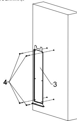
5. Затем приложите прибор к стене так, чтобы кронштейн оказался по центру прибора, после опустите прибор на кронштейн. Признаком того, что прибор успешно установлен на кронштейн будет его надежная фиксация и явное сопротивление попыткам сместить прибор в бок или вниз:
