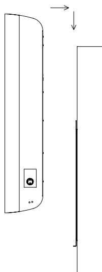
6. После успешной установки прибора на кронштейн закрутите саморезы 1 на прежние места.
