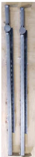
Стояночные нагреватели предназначены для обогрева картера наружного блока и равномерной выработки ресурса наружных блоков системы кондиционирования. В комплект ВСМ-СНС-6/1 входит две пары нагревателей. Каждый из них состоит из нагревательного элемента ТЭН 140А8/0,5-S-220В в защитном оцинкованном металлическом корпусе, керамических клеммных колодок К4716, К4720, провода термостойкого 400С CNVAS алюминиевой распаячной коробки и крепежных элементов.
