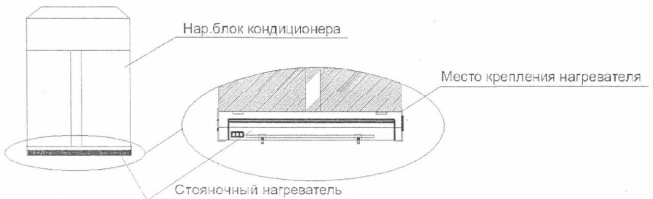
Рекомендуется для удобства монтажа перед установкой стояночных нагревателей на опорную раму подсоединить к ним провода  $\approx 2$ м и надеть гофру.
