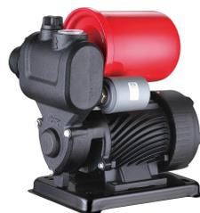
**JET, SGJ** Поверхностный центробежный одноступенчатый самовсасывающий моноблочный насос для бытового холодного водоснабжения и повышения давления в системах холодного водоснабжения, полива и перекачивания чистых вод из скважин и колодцев.
