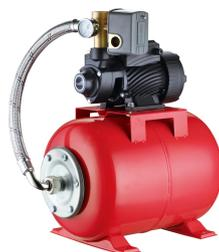
**TGP** Насосная станция с реле давления и гидроаккумулятором 2 литра, на основе насоса поверхностного нормально-всасывающего вихревого моноблочного насоса, предназначена для использования в системах водоснабжения для повышения давления. Подходит во всех случаях, когда в перекачиваемой воде вероятно наличие воздуха или газа. Работает в автоматическом режиме.
