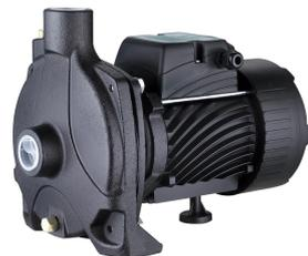
**QB** Поверхностный вихревой одноступенчатый нормальновсасывающий моноблочный насос с радиальным потоком, предназначенный для подачи чистой воды и других жидкостей со сходными физическими или химическими свойствами. Может использоваться для подъёма из скважин и колодцев, полива, повышения давления воды в системах водоснабжения.
