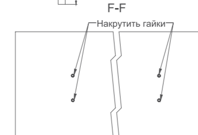
Расположение монтажных кронштейнов для горизонтальной установки занавески на резьбовые шпильки
