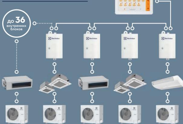
Схема управления кондиционированием в BMS
