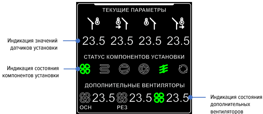
Рис. 9. Информация о состоянии компонентов установки
