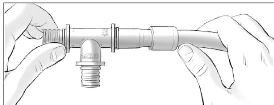
Вставьте в расширенную трубу фитинг до упорного бортика фитинга.
