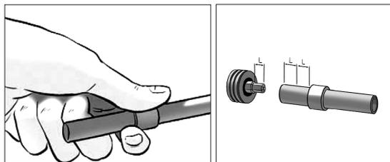
Наденьте пресс-гильзу на трубу фаской в сторону присоединения. Пресс-соединение должно монтироваться на прямом участке трубы (без изгибов) минимальной длиной, равной трём гильзам. При расширении трубы гильза должна находиться на расстоянии от края трубы, равном длине минимум двух гильз.
