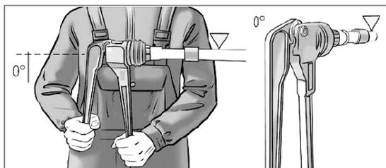
Подготовьте расширитель, накрутите на него насадку для расширения трубы, которая соответствует диаметру трубы.
