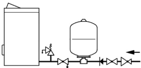
При монтаже расширительного бака обязательно использование предохранительного клапана, либо группы безопасности. При использовании группы безопасности с обратным клапаном - группу безопасности нужно монтировать перед расширительным баком со стороны линии ХВС. Расширительные баки рекомендуется устанавливать на линию подачи холодной воды. На линии не должно быть сужения трубопровода.
