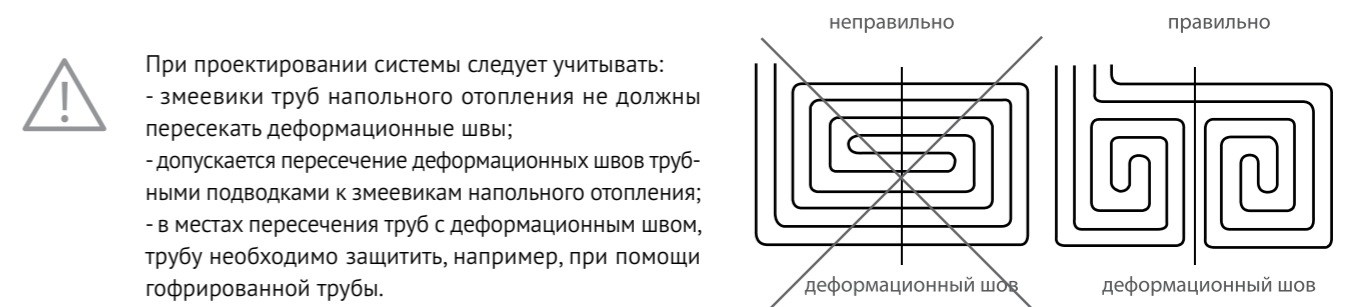
Рисунок 44. Пересечение деформационного шва
