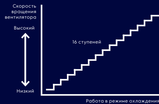
Упрощенная схема 16-ти ступенчатой регулировки скорости вращения вентилятора наружного блока в условиях режима охлаждения.
