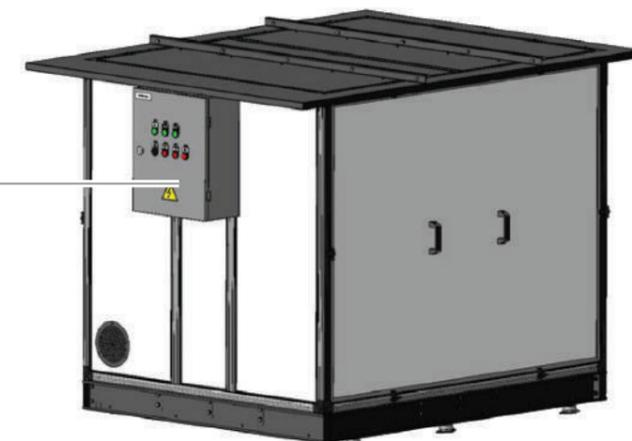
Все гидромодули, как во внутреннем, так и в наружном исполнении укомплектованы шкафом электроподключений, который содержит выключатели, пускатели, контакторы, реле для ввода резервного насоса в работу и равномерной наработки моточасов.
