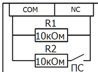
COM и NC на рисунке – контакты в щите, используемые для подключения сигналов «Сигнал “Пожар” от системы АПС» и «Сигнал “РИП” от системы ПС» (для сигнала РИП должны использоваться NO-контакты, т. е. разомкнутые при отсутствии срабатывания пожарной сигнализации, для АПС – NC); ПС – контакты непосредственно данных сигналов.
