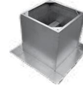
Крышные корпуса RCS из оцинкованной стали с шумоглушителями для монтажа вентиляторов (I)RMV на плоской кровле. Шумоглушающий материал обладает стойкостью к износу при скорости воздуха до 20 м/с.
