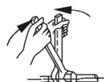
3. Установите соединительный трубопровод на нужную позицию, закрутите гайки рукой, затем затяните их с помощью гаечного ключа.
