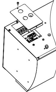
Завесы ВНС-В10Т06-PS2 и ВНС-В15Т06-PS2 изначально предназначены для подключения к однофазной сети 230 В. Также завесы ВНС-В10Т06-PS2 и ВНС-В15Т06-PS2 можно подключить и к трехфазной сети 400 В. Для этого необходимо удалить перемычку между клеммами L1, L2 и L3.
