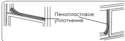
4. Отрежьте пенопластовый уплотнитель В (неклейки) по ширине окна. Разместите пенопластовый уплотнитель В между стеклом и окном, чтобы воздух и насекомые не попали внутрь комнаты
