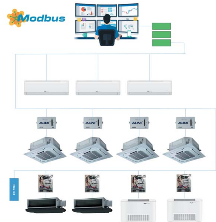
Подключение фанкойлов к системе диспетчеризации
