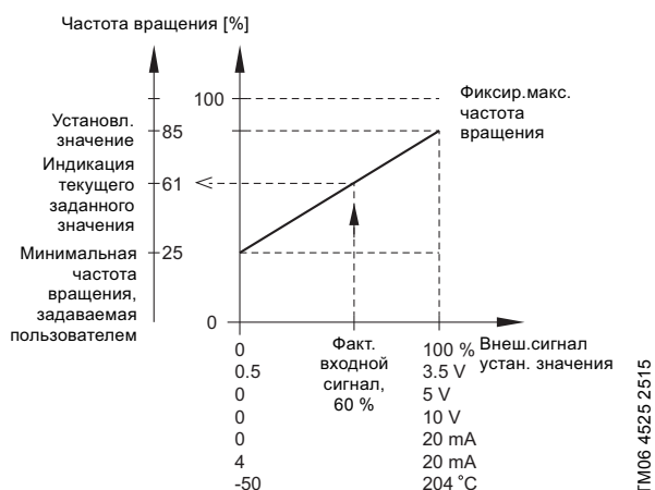
Рис. 73 Пример влияния установленного значения с постоянной характеристикой
