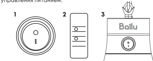
1 – Выключатель 2 – Пульт ДУ 3 – Расположение выключателя на корпусе прибора
