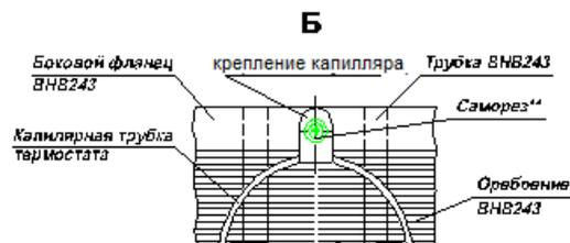
**Примечание:** Термостат должен находиться в более теплом месте, чем чувствительный элемент.
