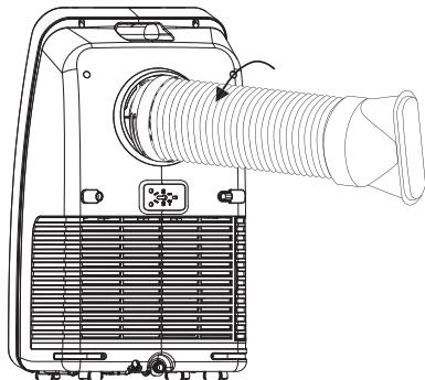
2. С помощью насадки-адаптера организуйте вывод шланга для выброса теплого воздуха в окно с помощью переходника, либо в другое помещение (например, техническое) за пределы охлаждаемого в ближайшем окне или в специальном отверстии для отвода теплого воздуха.
