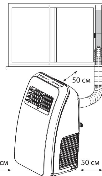
1. Выберите подходящее место для установки кондиционера с удобным доступом к электрической розетке.
