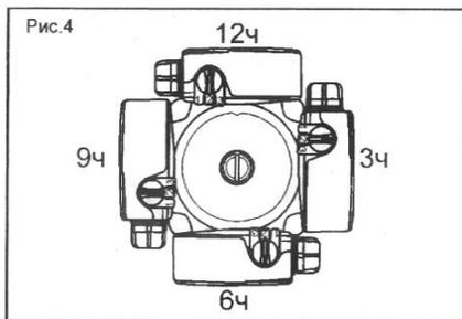
При необходимости можно изменить расположение мотора, а значит и клеммной коробки.
