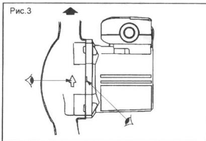
3. Стрелка на корпусе насоса указывает правильное направление вращения мотора. (рис.3)
