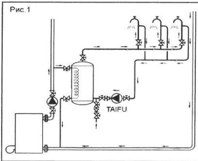
1. Насос должен быть установлен в легко доступном месте. Монтаж осуществляется непосредственно на горизонтальный или вертикальный трубопровод.
