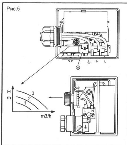
При замене шнуров питания подключение проводов к клеммам следует производить согласно схемам ниже
