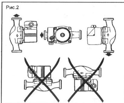
2. Расположение мотора должно быть строго как на рисунке. (рис.2)
