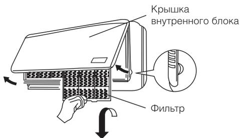
1. Поднимите крышку лицевой панели двумя руками в направлении на себя и вверх.
