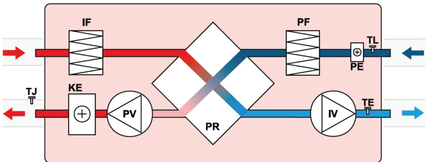
PV – вентилятор приточного воздуха;
