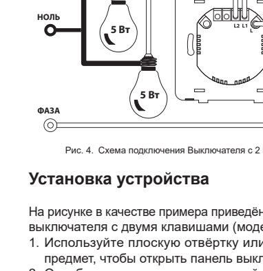
Рис. 4. Схема подключения Выключателя с 2 клавишами (без нуля)
