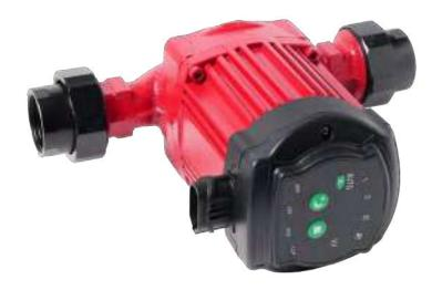
Циркуляционный насос представляет собой специализированный насосный агрегат с «мокрым» ротором, который предназначается для создания принудительной циркуляции жидкости в закрытых системах отопления при стабильном или слабо меняющемся расходе. Ротор мотора располагается непосредственно в перекачиваемой среде, ротор от статора отделяет гильза из нержавеющей стали, подшипники смазываются и охлаждаются
