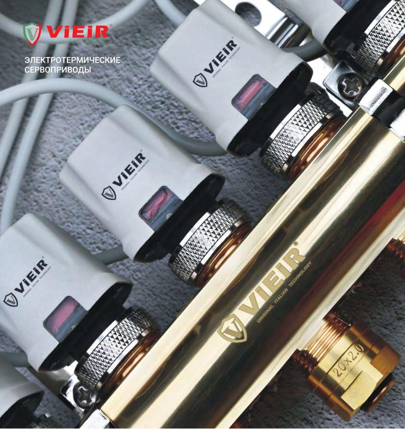
Электротермические сервоприводы предназначены для управления термостатическими клапанами климатических систем по команде комнатного термостата, контроллера или ручного переключателя, в процессе работы сервоприводы обеспечивают автоматическую корректировку нагрева отопительных приборов и поддерживают комфортную температуру воздуха в помещении.
