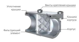
Фильтр газовый Vieir VRQ25, VRQ26 предназначен для установки на линии подачи газа для настенных или напольных котлов или бытовых газовых водонагревателей, основная функция изделия заключается в очистке транспортируемой среды от механических примесей, окалины, металлической стружки и твердых частиц.
