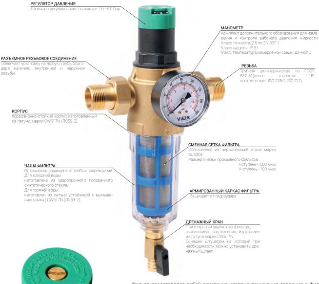
Фильтр представляет собой сочетание клапана понижения давления с фильтром тонкой очистки в одном устройстве, применяется для очистки потока жидкости от нерастворимых механических примесей в системах трубопроводов горячей и холодной воды, сжатого воздуха, масла и жидких углеводородов при температуре транспортируемой среды до 80°C.
