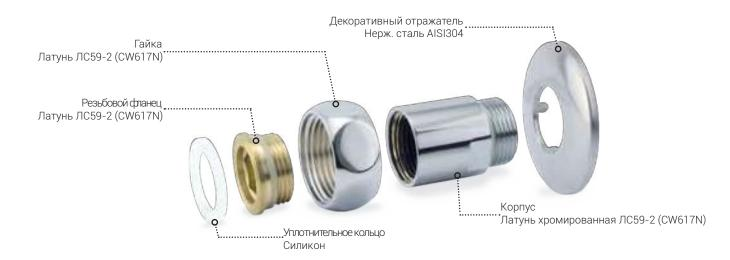
Фитинги и комплектующие для полотенцесущителей VIEIR предназначены для монтажа и комплектации полотенцесущителей. Применяются при монтаже систем с номинальным давлением до 16 бар и рабочей температурой до 100°С. Фитинги имеют дюймовую цилиндрическую резьбу по DIN ISO 228/1. В комплект фитингов входит декоративный отражатель и дополнительно уплотнительный материал из силикона, что позволяет создавать разборные соединения без применения дополнительного уплотнительного материала.
