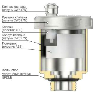
В процессе работы системы поплавковые воздухоотводчики предохраняют закрытые системы трубопроводов от появления коррозии и воздушных пробок, а также от образования кавитационных шумов.
