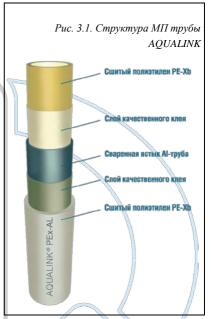
сшитого полиэтилена PE-Xb (силановая сшивка) и соединяются со слоем алюминия с помощью качественного адгезива, который не позволяет трубе расслаиваться. Алюминиевая фольга сварена встык (TIG-сварка).
