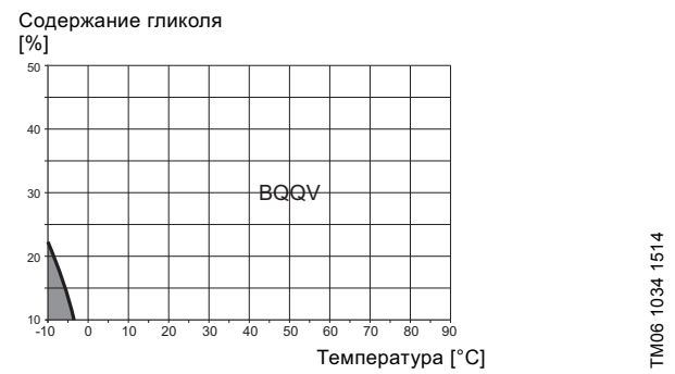
Рис. 6 Рабочий диапазон торцевых уплотнений из FKM
