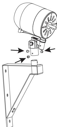
3. Блок управления установить движением сверху вниз на выступающую часть кронштейна.
