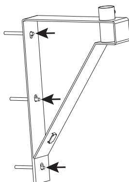
2. Вентилятор в сборе установить на кронштейн и закрепить тремя болтами M6.
